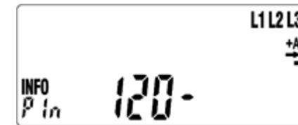
Zur Eingabe der PIN leuchten Sie zwei Mal auf die optische Taste. Nach dem Displaytest (alle Anzeigeelemente werden eingeblendet) erfolgt die PIN-Abfrage.
