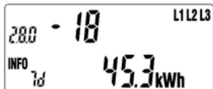
Für die historischen Werte „1 d“, „7 d“, „30 d“, „365 d“ erfolgt eine Aufzeichnung über 24 Monate. Dies bedeutet 730 „1d“, 104 „7 d“, 24 „30 d“, 2 „365 d“ Werte. Die einzelnen historischen Werten (730 x „1 d“, 104 x „7 d“, 24 x „30 d“, 2 x „365 d“) können über einen „langen Tastendruck“ (5 s) auf dem jeweiligen Wert ohne Counter erreicht werden. Durch einen „kurzen Klick“ werden die einzelnen
