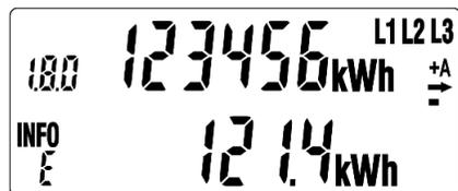
Der Endkunde hat die Möglichkeit, über das Bedienelement jederzeit diesen historischen Wert zurückzusetzen. Die „Historischen Werte seit letzter Nullstellung“ werden nicht automatisch zu „Null“ gesetzt. Die Zählwerke arbeiten solange, bis sie manuell durch den Bediener zurückgesetzt werden.
